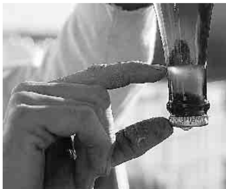
Tras la fermentación, los posos se depositan en el cuello de la botella. Tras congelarlos, se eliminan retirando el tapón provisional. :: A. G. / AGM
