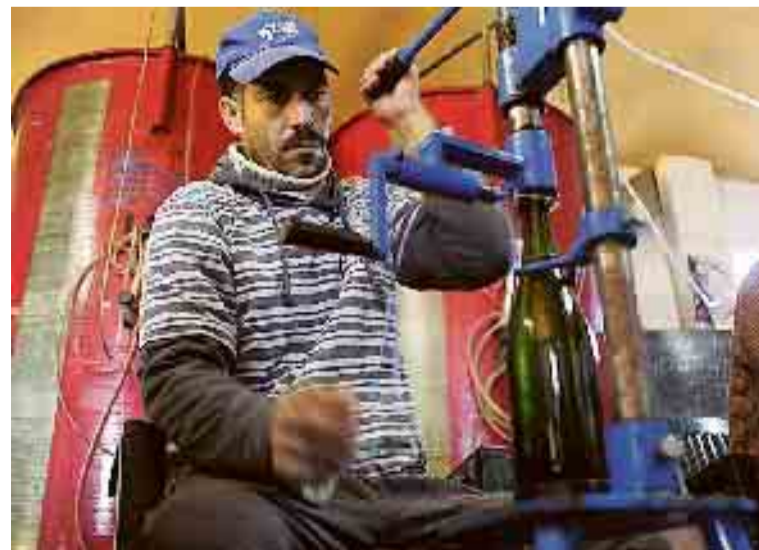
Miloude acciona una palanca para que el tapón de corcho de 32 milímetros encaje en el cuello de la botella, de sólo 18 . :: A. G. / AGM
